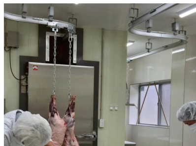
④ 加工室 「カーブレール」で複雑な導線に対応。
