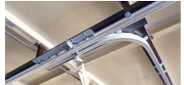
分岐用引き紐を1回引くと分岐側でレバーがロックされます。引き紐を少し横に引きながら引き下げるとロックが解除されレールが直進側にスライドします。
