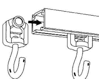
ランナーをレールの端部より挿入します。
