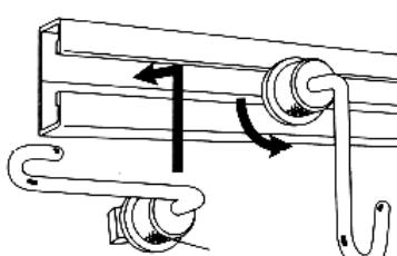
ランナーのローレットネジをゆるめ、受座をレール溝に差込み押しながら90度回転させます。
