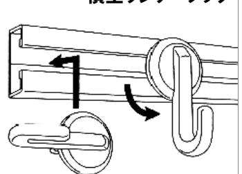
ランナー受座をレール溝に差込み押しながら90度回転させます。手を離すとハネの力で受座がレールに固定されます。
