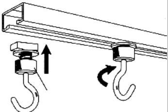
ランナーのローレットネジをゆるめ、受座をレール溝に差込み押しながら90度回転させます。
