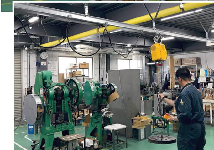
←工場 (金型交換時の移送や加工資材の移送)
