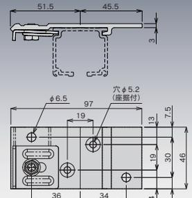
※爪固定ネジ (M6) の適正締付トルクは5.2N・mです。締めすぎるとアルミが破損し、保持力が急激に低下します。
