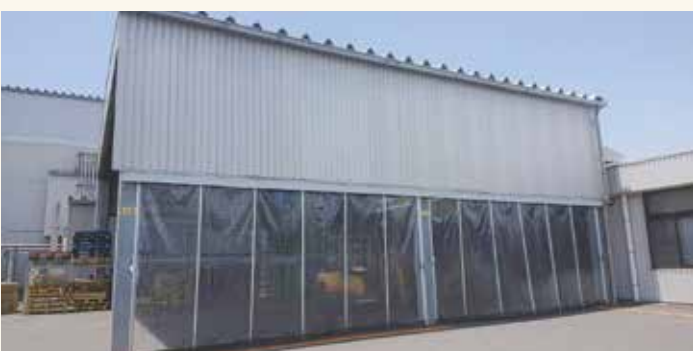
雨・風除け 防塵 ビニールシート、D40レール、間仕切ポール使用
